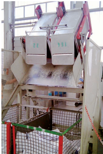
Leerung der Tonnen mit einer Hub-Kippvorrichtung
